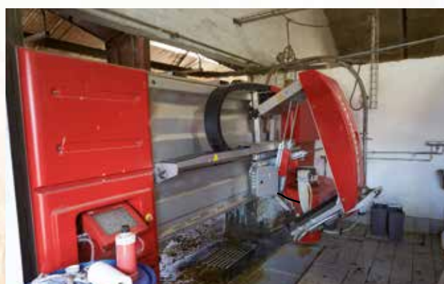
Malkebobotten rengøres med 90 grader varmt vand fra halmfyret.
